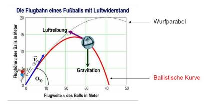
Die ballistische Kurve zeichnet sich dadurch aus, dass der rechte Ast der Parabel bedingt durch den Luftwiderstand schneller nach unten verläuft als bei einer symmetrischen Parabel. Der Verlauf ist **rechtssteil**. Der Luftwiderstand wird bestimmt durch die Masse und den sog. Reibungsfaktor, der eine Maßzahl aus Querschnitt und Oberflächenbeschaffenheit ist.
